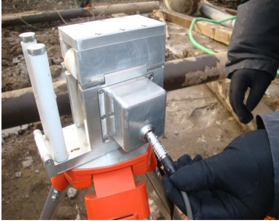
图 4 连接提升装置与主机间的信号线
