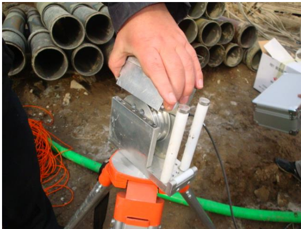
图 9 打开主动轮上的压线装置
