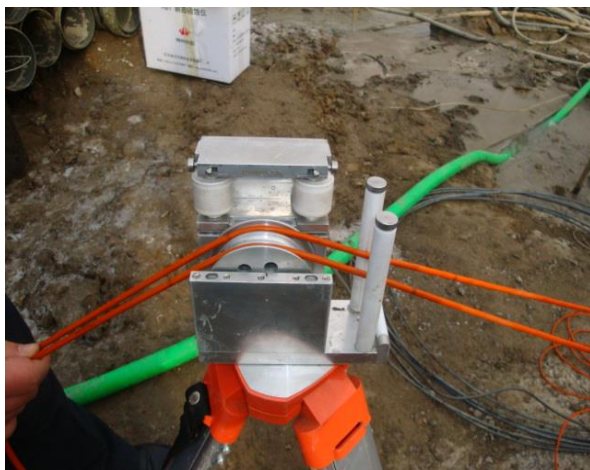
图 10 将收发换能器信号电缆放入主动轮线槽
