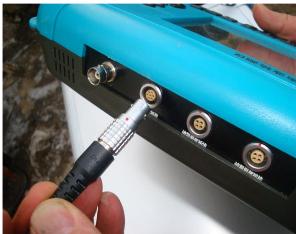
图 3 连接提升装置与主机间的信号线
