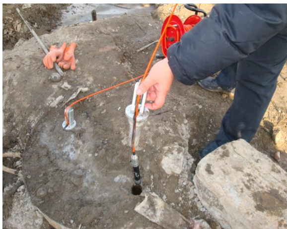
图 7 将径向换能器、从动轮部分放入声测管
