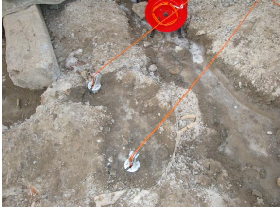
图 8 将探头放止桩底
