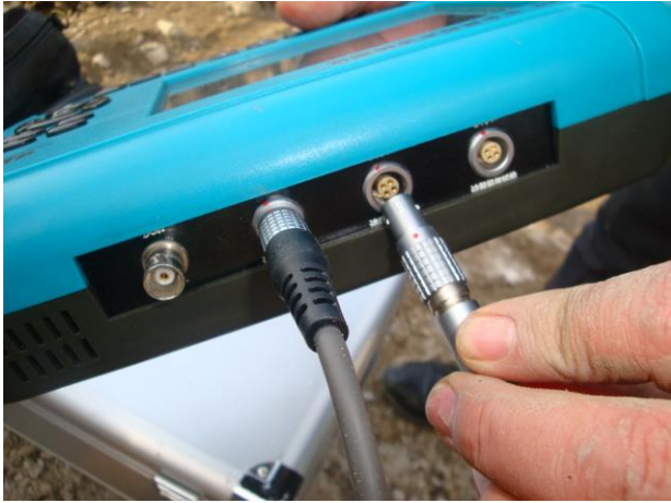
图 13 接上接收换能器接头
