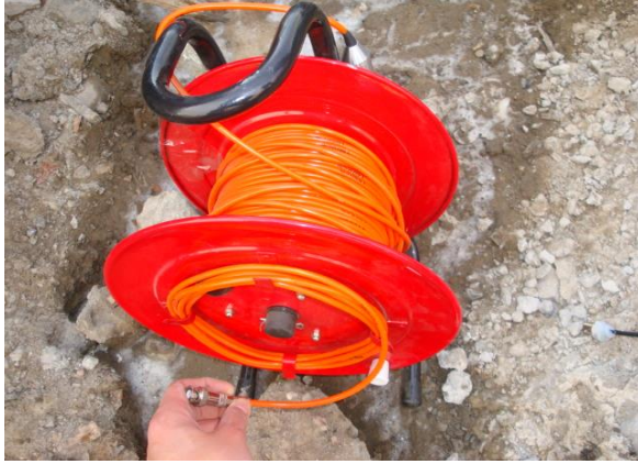
图 12 导下收、发换能器的信号线接头
