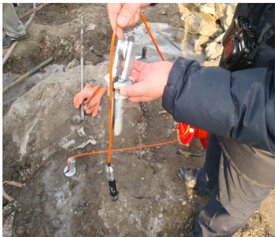
图 6 将径向换能器探头部分放入从动轮
