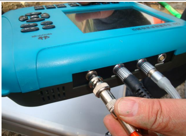
图 14 接上发射换能器接头
